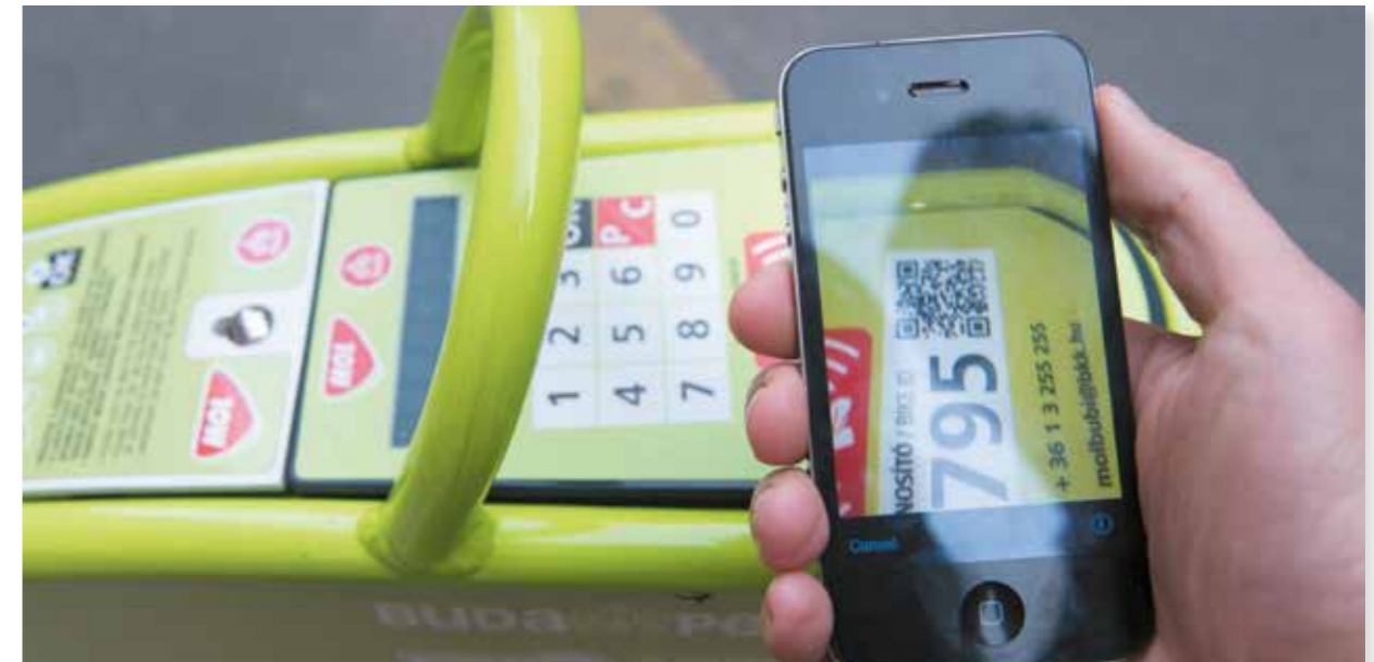
9. ábra: A közbringarendszerrel korábban ismeretlen innovációk jelentek meg Budapesten. A kerékpárok nem csak a gyűjtőállomások terminálján keresztül, hanem a fedélzeti számítógépének vagy az okostelefonos applikációnak a használatával is bérelhetők. A napelemes, emiatt különösen energiahatékony gyűjtőállomások telepítéséhez alig kell megbolygatni a meglévő infrastruktúrát, könnyen telepíthetőek nagy forgalmú helyekre is. Fotó: BKK
